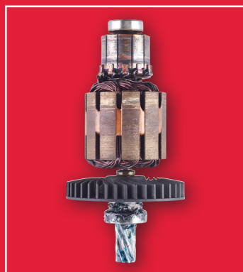
Spálený motor z důvodu přetížení
