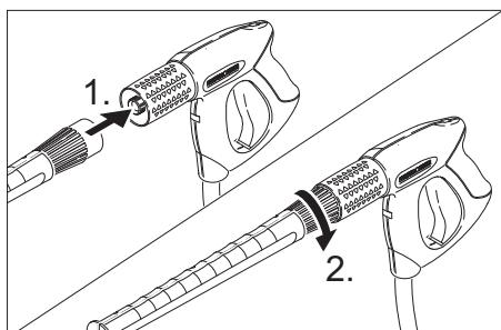
→ Свържете маркуча за работа под налягане и тръбата за разпръскване с пистолета за ръчно пръскане.
