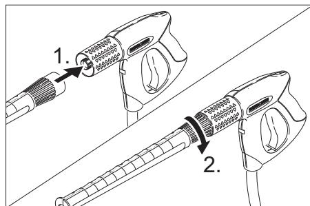
→ Соедините шланг высокого давления и струйную трубку с ручным пистолетом-распылителем.
